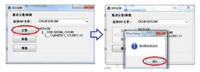
Щелкните правой кнопкой мыши Мой компьютер - Управление - Диспетчер устройств - Порт, чтобы узнать, отображается ли номер порта CH340. Если установка прошла успешно - появится COMx, запишите номер COM-порта.
