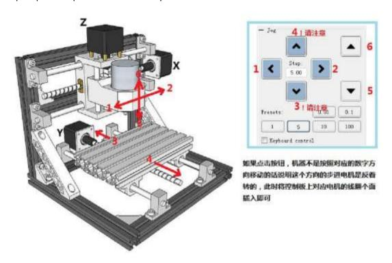
Если кнопка нажата и машина не движется в соответствующем цифровом направлении, то шаговый двигатель в этом направлении обратно. В это время линия, соответствующая двигателю пластины L, может быть повернута.
